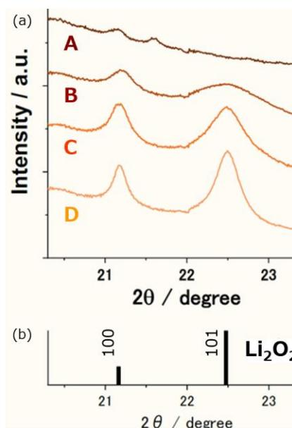
Fig. 1 (a) 条件A – Dで得られた電極材料の粉末X線回折 (b)  $\text{Li}_2\text{O}_2$ のBragg position
