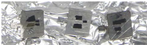
Fig.1 試料の固定状況 (BL7U/BL1N2 用ホルダ利用)
